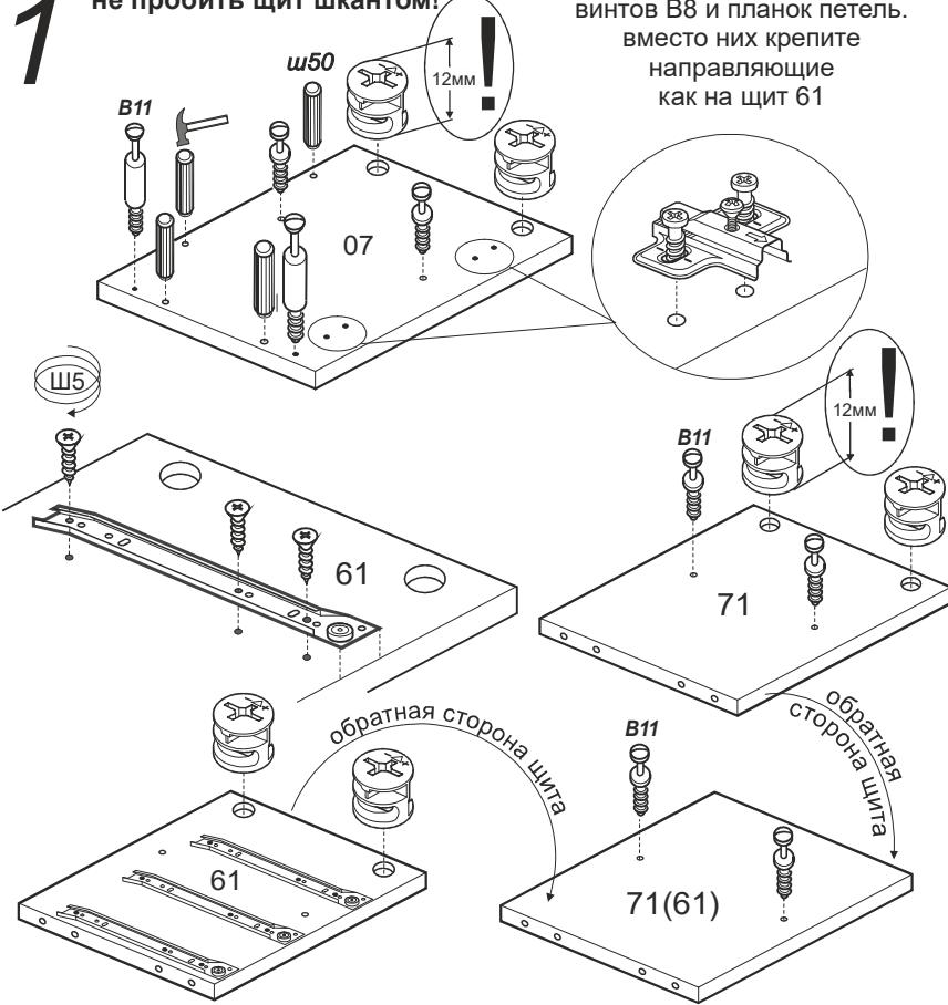
постановка фурнитуры на щит 06 аналогична щиту 07, за исключением винтов В8 и планок петель. вместо них крепите направляющие как на щит 61
